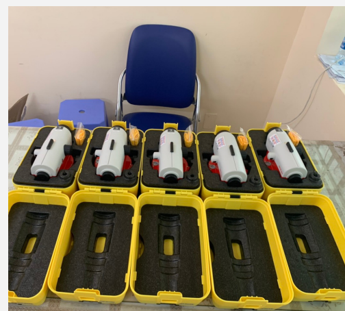
Máy thủy bình
